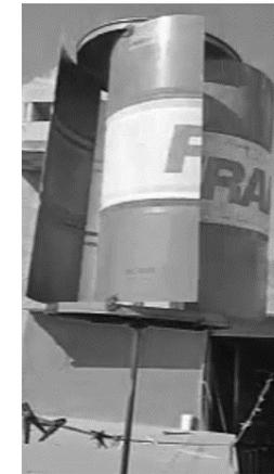
**Figura 6** Turbina de eje vertical Savonius *Fuente: Grupo de tribología y transporte. Facultad de ingeniería. BUAP*
